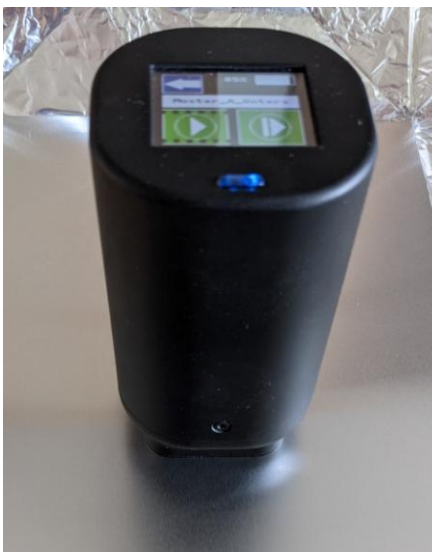
Abbildung 3: links: Messkopf steht auf dem Blech; Messung erfolgt direkt rechts: Auszug aus den Rohdaten zeigt deutlich erkennbare Riefen
