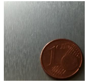
Abbildung 2: Aluminiumblech mit deutlich erkennbarer Oberflächenstruktur
