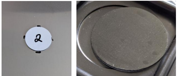
Abbildung 5: Probenahme mittels TapeLift Pad auf Alu-Blech (links); TapeLift Pad mit Partikeln (rechts)
